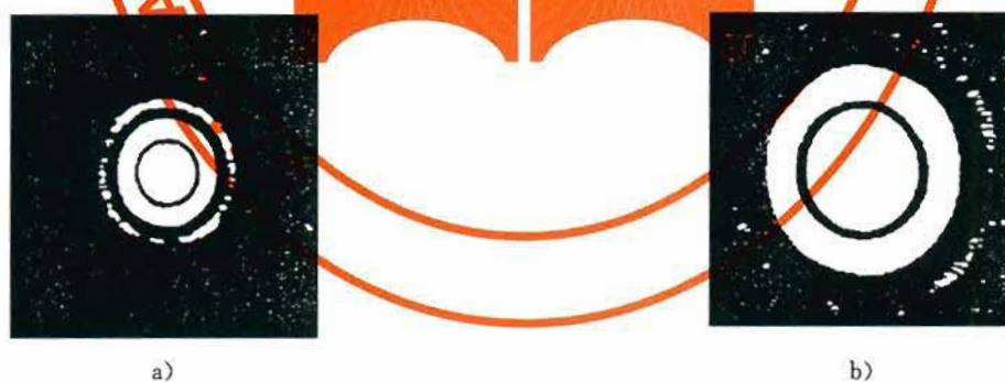
图1 两球形颗粒的散射图[产生图a)的粒径是产生图b)的粒径的2倍]
